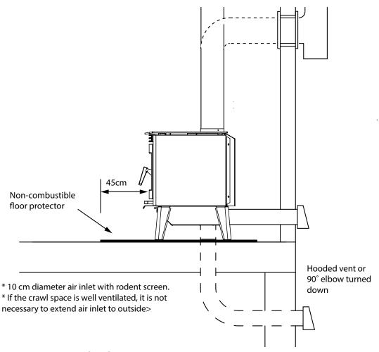
Figure 9. AB25 AUS INSTALL Diagram.
